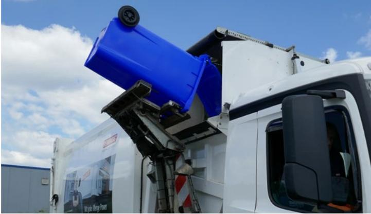
Prueba de elevación y vaciado
